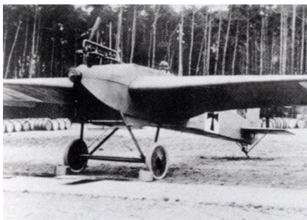
Junkers J1. Alemán. Aparecido en 1915, fue el primer monoplano metálico.
