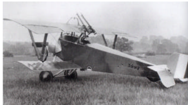
Nieuport II, Francés. El contrapunto a los Fokker alemanes, incluía una ametralladora sincronizada
