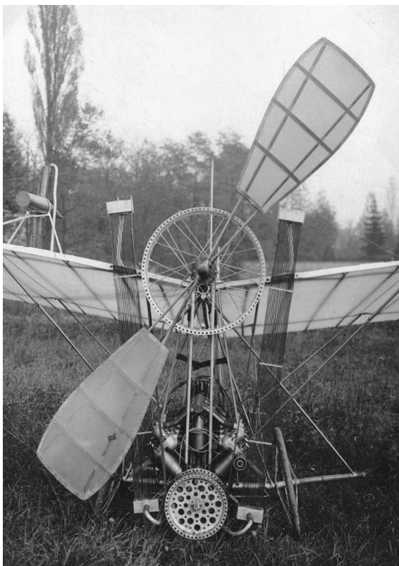
1907: Motor diseñado por Leon Levavasseur, para la aeronave Antoniette. Primeros motores que consiguieron disminuir el peso y aumen- tar la potencia.
